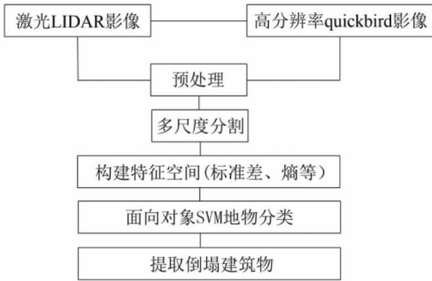
图2 基于 SVM 的多源信息面向对象倒塌建筑物提取流程
