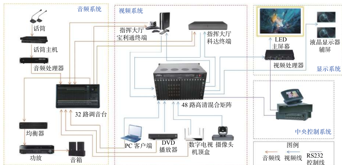
图 1 区地震局指挥大厅视频会议系统信号集成拓扑图
